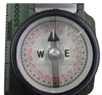
Skala des Lineatik-Kompasses mit Tritium Markierungen
