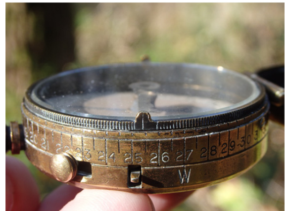
mittels Kimme und Korn wird nun das Ziel anvisiert und die Marschrichtung eingestellt und abgelesen
