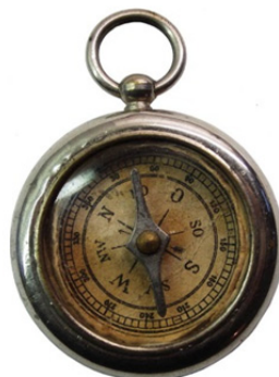
Taschenkompass Stockert im Uhrengehäuse um 1880
