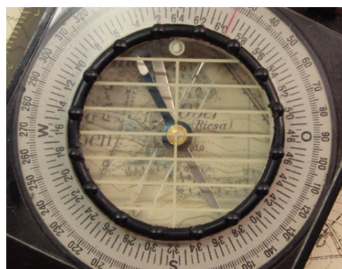
Paralleldrehen der Skala nach Ortsnamen
