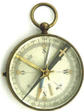
Metallskala mit Balmainpapier und Direktionslinie Quelle compassipedia
