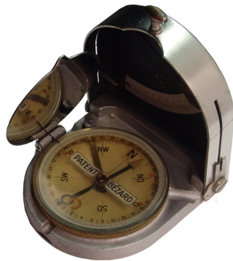
UBK – Patent-Bèzard mit 32-00 Strich versetzter Skala
