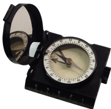
Marschkompass Pfadfinder von C. Stockert & Sohn der frühen 1930er Jahre mit fester Missweisungskorrektur
