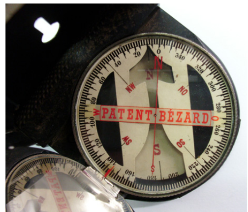
Magnetpfeil und Peilausschnitt werden deckungsgleich gebracht
