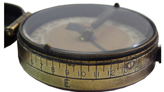
äußere Skala – Ablesung bei Draufsicht
