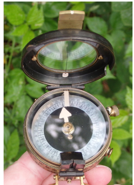
Ablesung der Marschrichtung ohne Prisma
