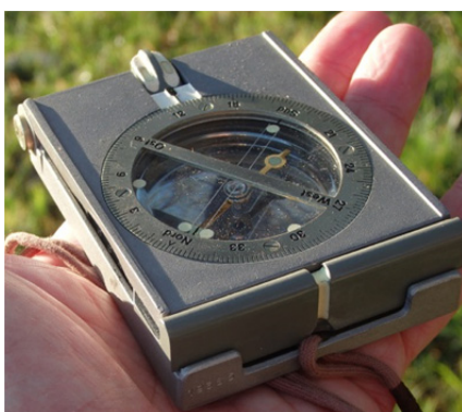
Einstellen der Marschrichtung an der seitlichen Rändelschraube
