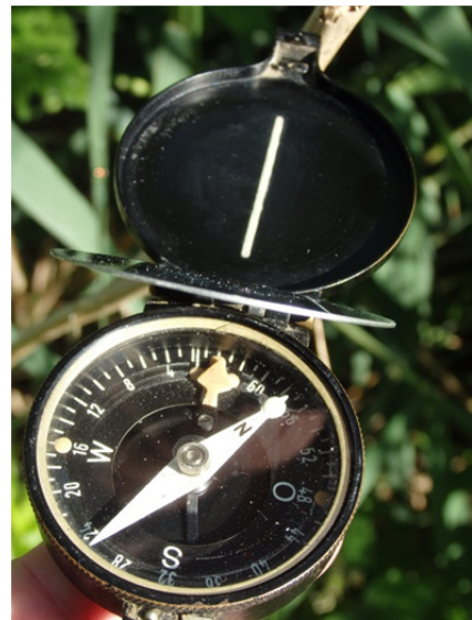
Marschkompass der Wehrmacht, ab 1936 mit Wirbelstromdämpfung
