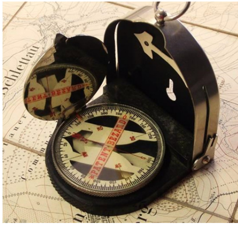
Orientierungs-Busssole des Oberstleutnant von Bèzard Armeemodell II aus dem Jahre 1910
