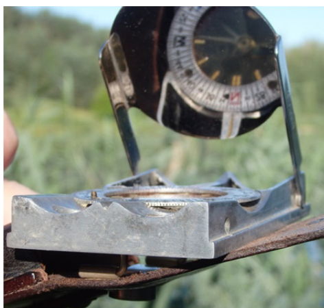
behelfsmäßiges Stillstellen der Nadel mittels des Etuis oder an Ästen
