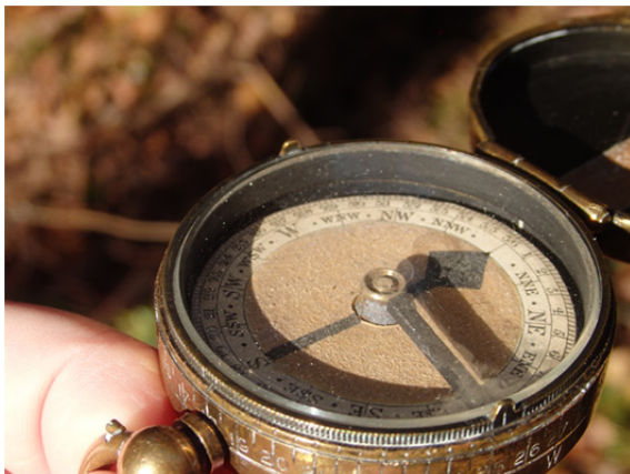
Nordpfeil wird auf die Nordmarkierung eingespielt
