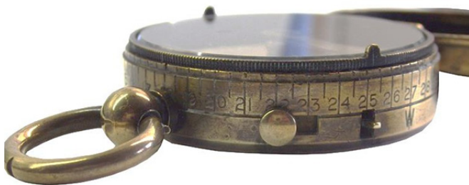
Kimme und Korn auf dem Gehäusedeckel
