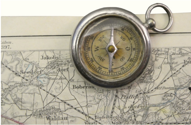
Karte des Deutschen Reiches 1:100.000 aus dem Jahre 1890 mit einem zeitgenössischem Taschenkompass von C. Stockert & Sohn beim Einnorden der Karte
