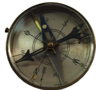
Geländekompass ohne Gradeinteilung mit Marschrichtungspfeil
