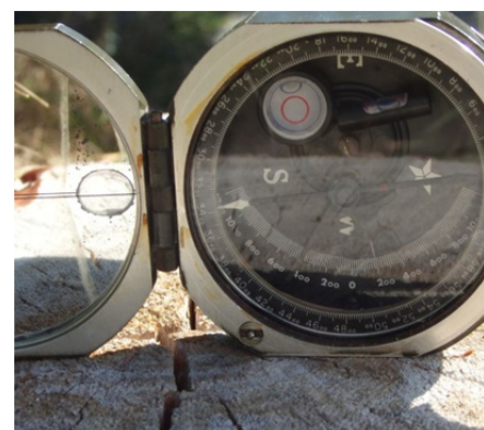
Ablesung der Neigung durch Einstellen der Röhrenlibelle
