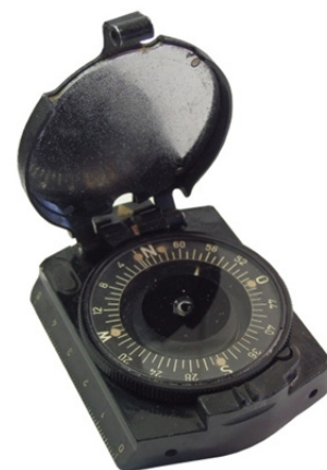
MK der Emil Busch AG mit Wirbelstromdämpfung
