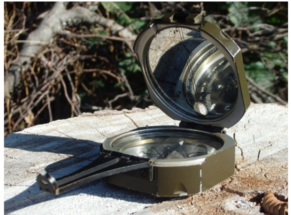
BRUNTON Geologenkompass, baugleich mit M2 Artilleriekompas der US Armee
