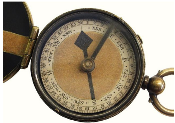
Skala 360 Grad rechtsdrehend
