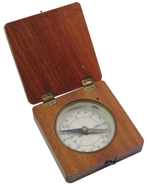
Zulegeinstrument für Meßtisch der Manufaktur Morin aus Paris gegen Ende des 19. Jh.
