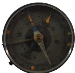
Geländekompass mit Marschrichtungspfeil, ca. 1916, mit radioaktivem Leuchtmittel
