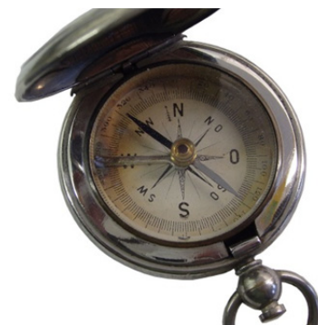
Taschenkompass in Uhrengehäuse auf Achathütchen
