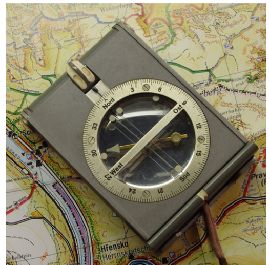
Kompassgehäuse und Skalenring
