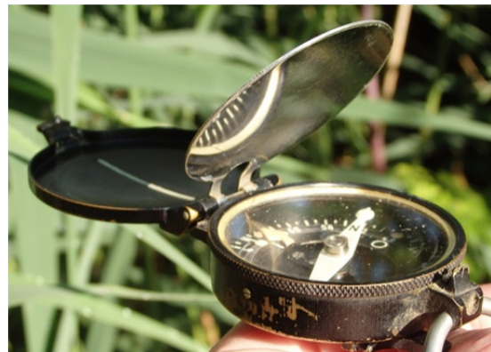
Busch Marschkompass I mit Wirbelstromdämpfung aus dem Jahre 1936
