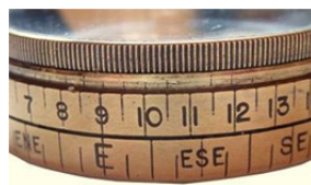
seitliche Beschriftung in Gradteilung und Himmelsrichtungen
