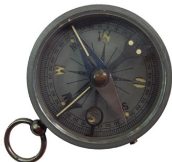
Armee-Kompass mit drehbarem Richtungspfeil
