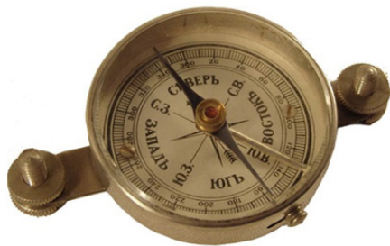
„Planchette-Kompass“ mit Gradeinteilung und Achatlagerung und Nadelarretierung
