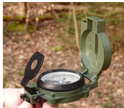
Cammenga Marschkompass der US-Streitkräfte mit Tritium
