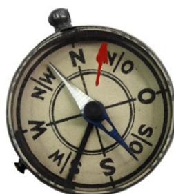
Militärkompass mit aufgemaltem und drehbarem Marschrichtungspfeil, blau nachleuchtend
