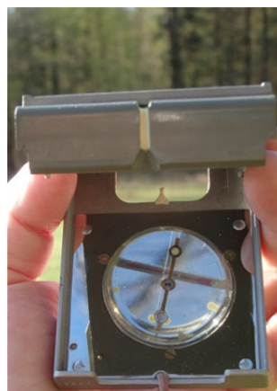
Anvisieren des Ziels über die am Deckel angebrachte Kornmarkierung
