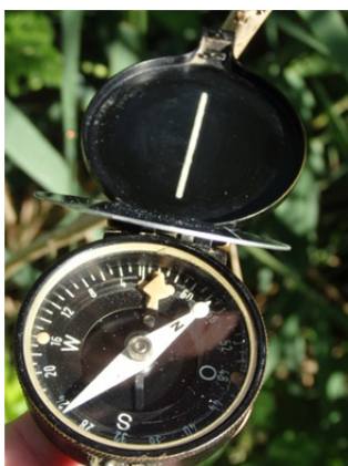
Ableitung an der Kompassnadel
