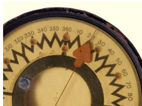
Einstellen der Marschrichtung von 20 Grad um sich die Marschrichtung zu merken oder um diese ins Gelände / in die Karte zu übertragen
