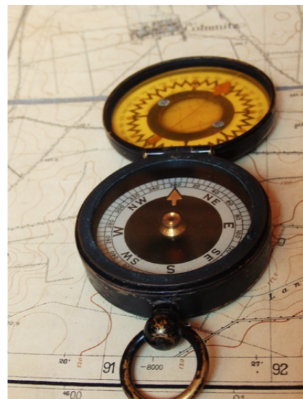
Übertragen der Marschrichtung in die Karte
