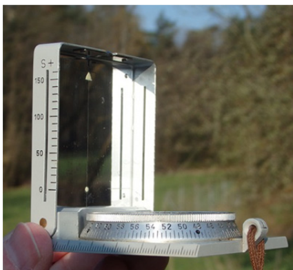
M-53 von Teleoptik Ermitteln Gefälle und Steigungen
