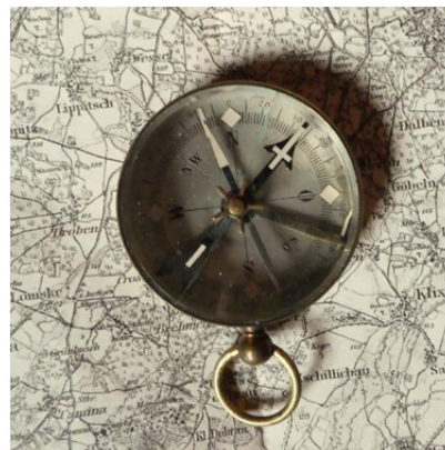
Bussole beim Einnorden mit Berücksichtigung der Deklination
