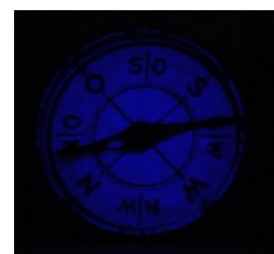
blau nachleuchtend mit Kennzeichnung der Nadelnordseite
