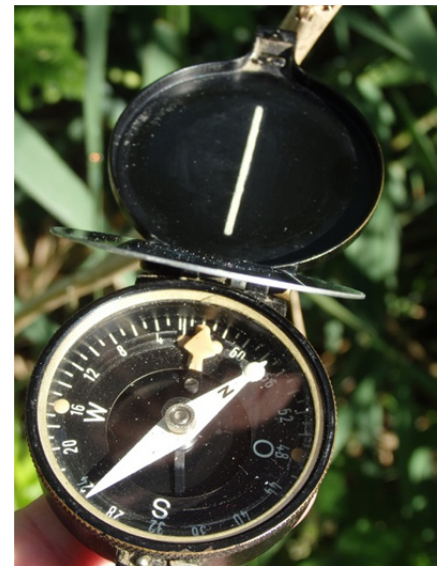
Marschkompass I hier mit Wirbelstromdämpfung aus dem Jahr 1936
