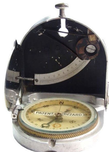
Modell II mit Pendleinrichtung ohne Libelle aus den 1920er Jahren
