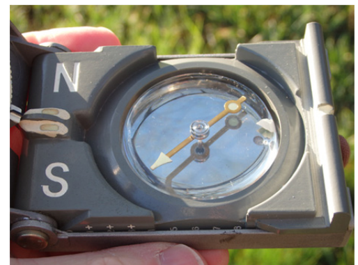
Kompasskapsel mit Magnetnadel
