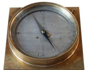
Kompass (Bussole) als Zulegeinstrument aus dem Jahre 1757 Bild aus dem Museum in Lauenstein
