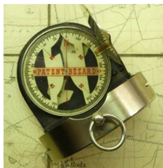
Nordpfeil kann vernachlässigt werden, nur Skala wird nach Karten-Nord orientiert
