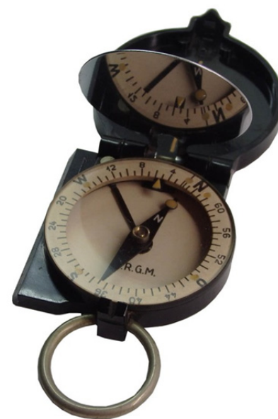
MK II mit einem großen Teilkreis, welcher in 64 Intervallen eingeteilt ist
