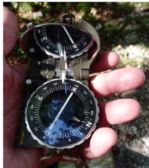
Ermitteln der Marschkompasszahl im Gelände
