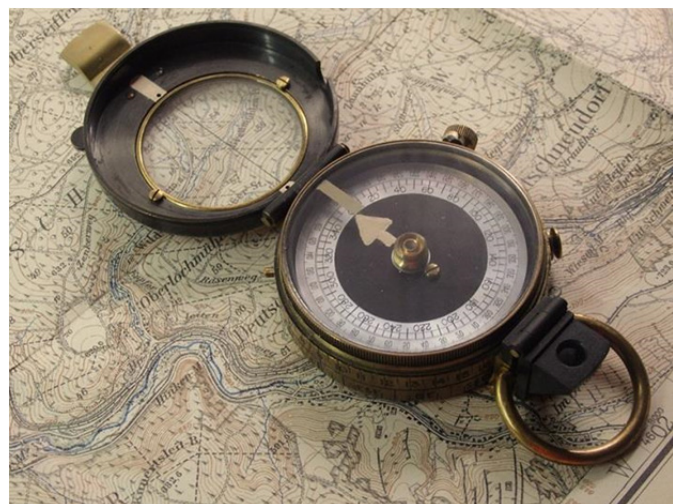
Einnorden der Karte mittels Peilstrich im Deckelglas
