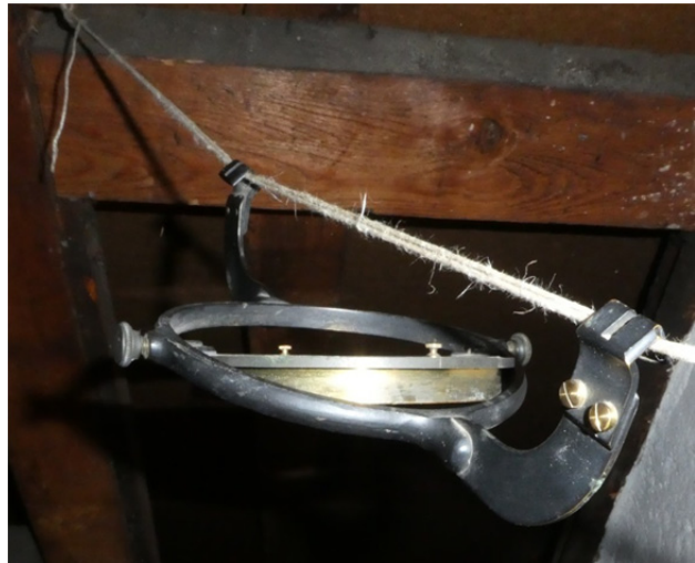
Hängekompass mit seiner kardanischer Aufhängung
