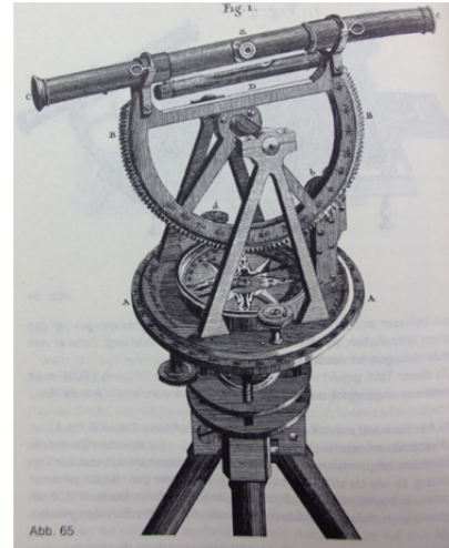
Theodolit mit teleskopischen Dioptern
