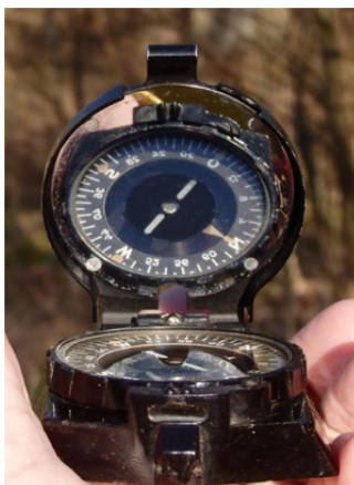
Vorläufermodell des Emil Busch MK Göttingen, Gehäuse aus Bakelit und ohne Visierstrich im Deckel
