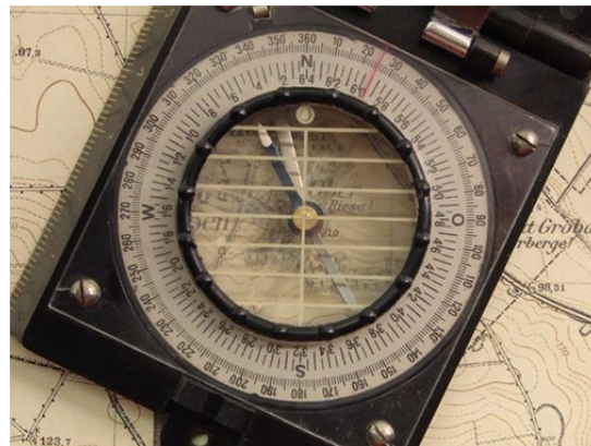
Nutzen der W-O-Linien ohne Parallaxenfehler
