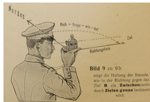
Die Haltung der Bussole aus der Gebrauchsanleitung 1910
