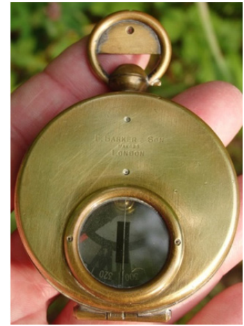
AbleSEN der Marschrichtung bei geschlossenem Deckel
