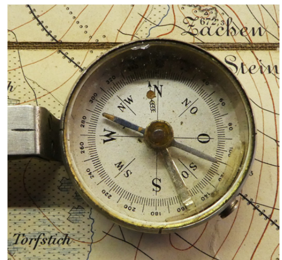
Kompasskapsel rechtsdrehend 360 Gradteilung
