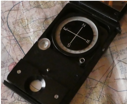
Ermitteln der Marschrichtung aus der Karte , rechts ein französischer Lemaire Marschkompass aus den 1940er Jahren zum Vergleich
