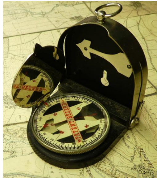
Bèzard Kompass Modell II ohne Radiummarken aus dem Jahr 1910
