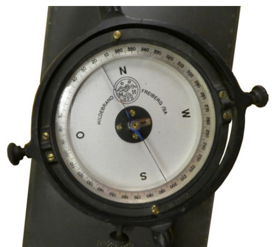
Skala 360 Grad linksdrehend
