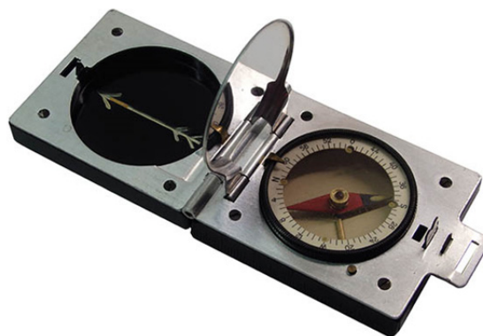
Marschkompass Modell I von C. Stockert & Sohn mit verstellbarer Missweisungskorrektur
