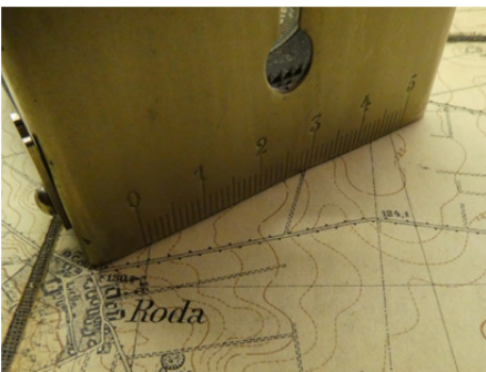
Anlegekante anlegen an Start und Ziel auf der Karte
