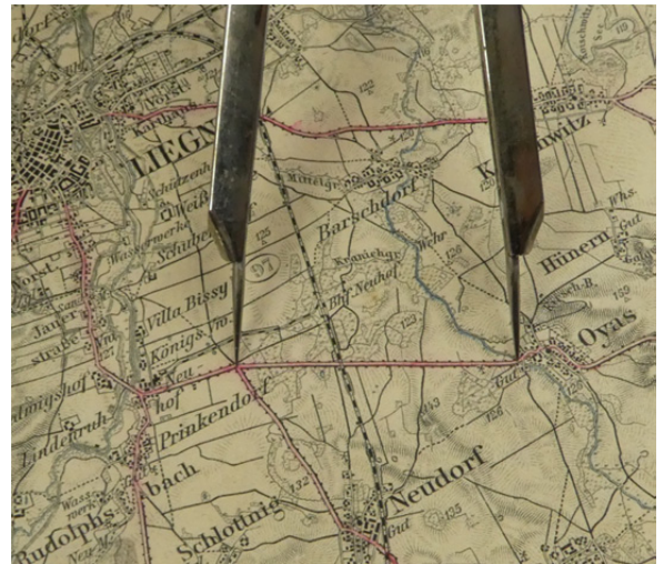
Strecke mit dem Stechzirkel abgreifen
