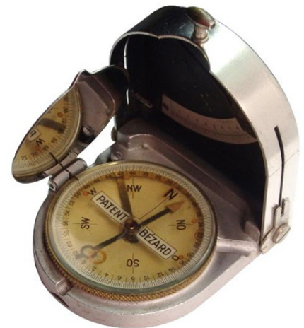
UBK - Bèzard Kompass mit vier Radiumhilfsmarken
