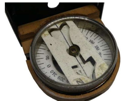
rechtsdrehende Skala in 360 Grad
