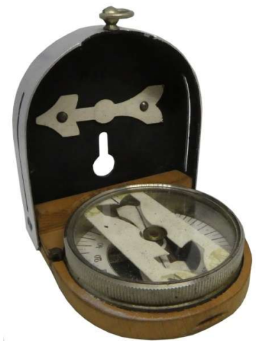
Diopterbussole aus dem Jahre 1905 nachleuchtend durch Balmainflüssigkeit
