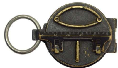
Gehäuseboden Armeemodell mit umklappbarer Anlegekante
