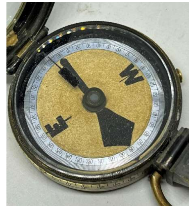
Skala für die Ablesung in 360 Grad
