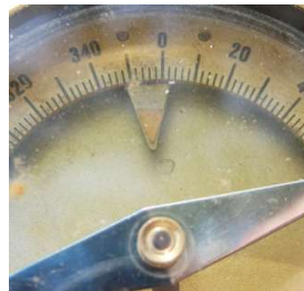
Deklinationskorrektur mit 5 Grad West
