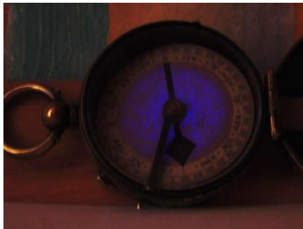
Skala nachleuchtend mit stark herausstechendem Marschrichtungspfeil
