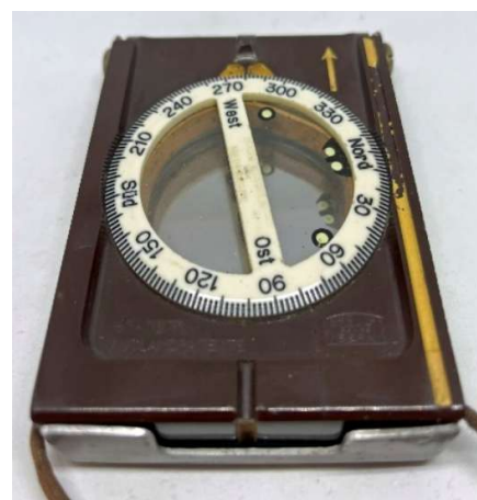
Kompassgehäuse aus Bakelit und einem Metalldeckel
