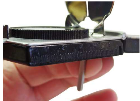
Haltemechanismus des Marschkompasses I Patent 1936 – D.R.P.
