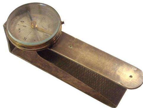
Taschenkompass Houlliot mit Klammer zum Befestigen einer Karte auf einem Meßtisch
