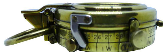
Arretierhebel des Kompassrose
