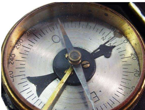
Gaumont Skala Modèle 1922 400 gon Skala
