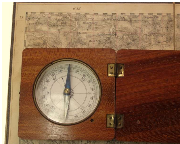
Morin Kompass im Holzgehäuse mit Deklinationskorrektur von 22 Grad West, ca. 1885, Frankreich auf Meßtischblatt von 1879
