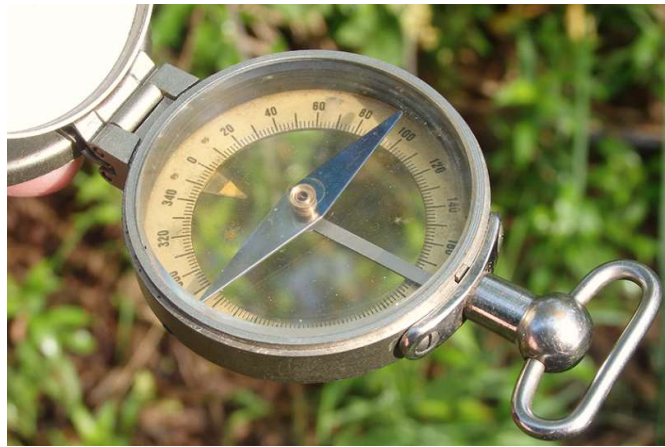
Skala Marschkompass Kröplin Modell 2 mit zurückgeklappten Bodendeckel
