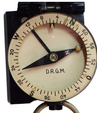
Skala 64-00 Strich linksdrehend mit D.R.G.M.
