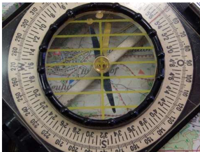
Kührt II mit Steinlagerung der Nadel
