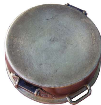
Messingdeckel schützt die Skala
