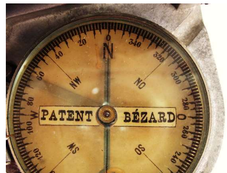
Skala 360 Grad linksdrehend
