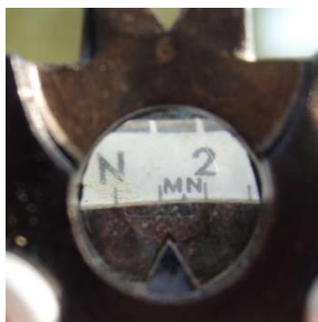
Magnetisch Nord Markierung auf der Skala
