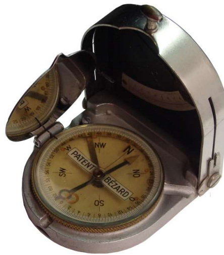
UBK – Patent-Bézard mit 32-00 Strich versetzter Skala
