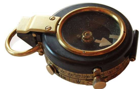
Messinggehäuse mit Skala aussen
