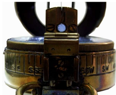
Anvisieren über Prisma und Visierstrich
