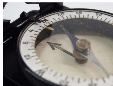
Kupferring unterhalb der Kompassnadel für „Kompass ruhig einspielend“
