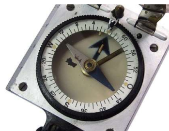
Skala 64-00 Strich linksdrehend mit nachtleuchtendem Marschrichtungspfeil
