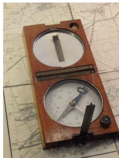
Einnorden der Karte an der Meridianlinie (Magnetnadel funktioniert leider nicht mehr)
