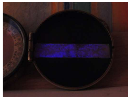
Orientierungsstrich nachleuchtend für das Anpeilen der Marschrichtung
