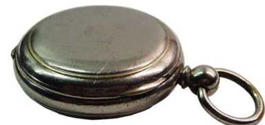
mit geschlossenem Deckel als Schutz vor Beschädigungen der Skala
