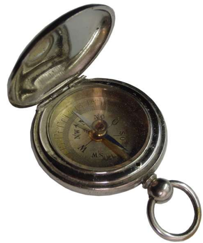
Taschenkompass im versilberten Uhrengehäuse ohne Sprungdeckel
