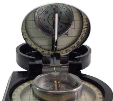
Verwendung als Marschkompass mit Nutzung des Spiegels
