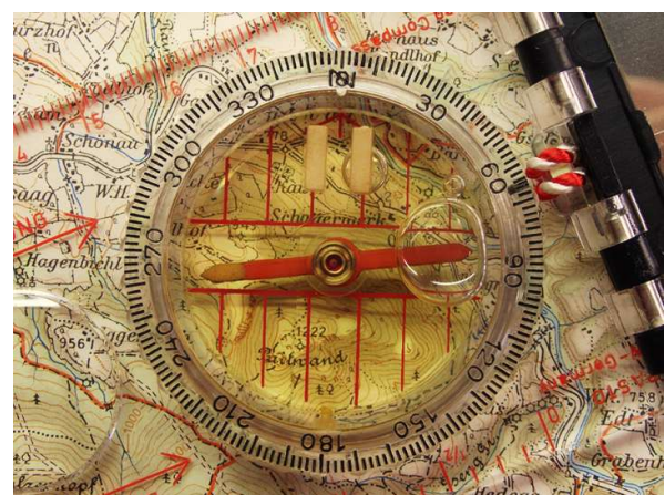
Ermitteln der Marschrichtung aus der Karte durch Anlegen der Ost-West Linie an Ortsnamen
