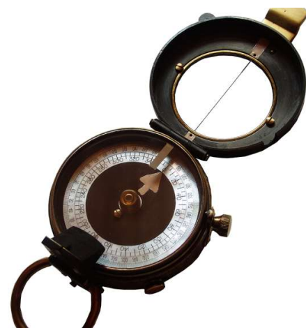
Perlmutterscheibe für eine Ablesung selbst bei widriger Witterung
