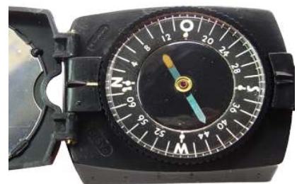
Skala mit Deklinationskorrektur
