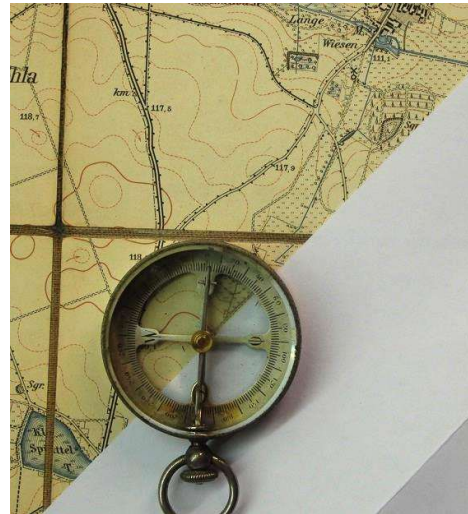
Ablesen der Marschrichtung an der Schnittlinie Gradeinteilung und Papierstreifen
