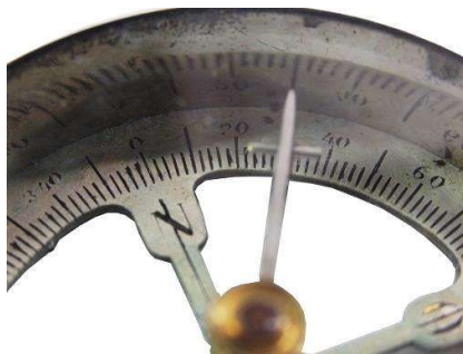
Die Skala spiegelt sich am vernickelten Gehäuse wieder um die Ablesung auf der Karte zu optimieren
