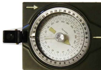
das Prisma mit der Kompassrose mit äußerem Teilring und innerer Einteilung in 360°
