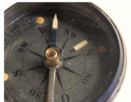
Skala mit Gradeinteilung und Achathütchen der Kompassnadel
