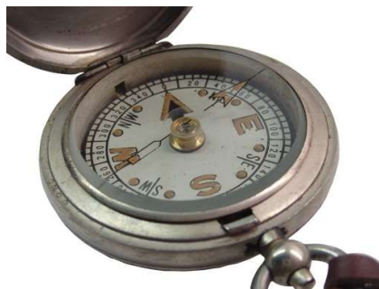
Vernickeltes Gehäuse mit radioaktiven Elementen der Skala
