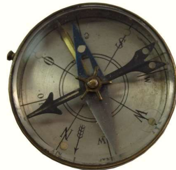
K. S. Stockert Modell Nr. 7 eigener Deklinationspfeil
