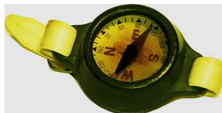
im Vergleich dazu ein WILKIE Kompass , erkennbar an der Stabilisierungsflügeln
