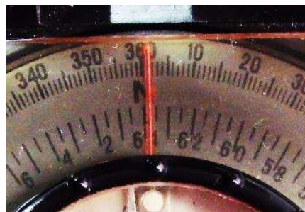
Kombinierte Skala in Grad und Strich
