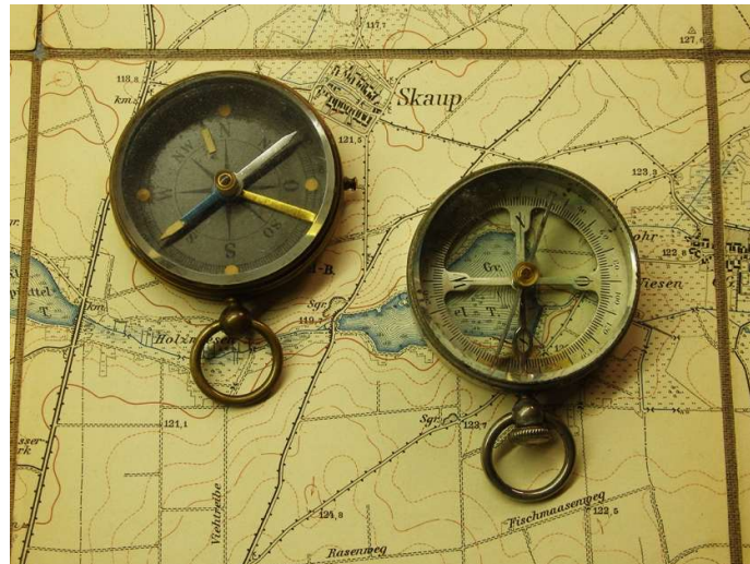
Unterscheid eines Kartenkompasses zu einem „normalen „ Einsatzkompass auf einer Meßtischkarte des Jahres 1905
