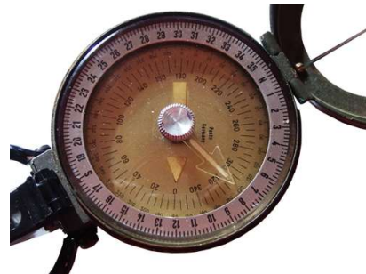
Skala mit Marschrichtungspfeil des M 206 S
