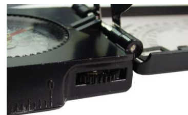
Rändelrad zur Einstellung der Skala / Marschrichtung
