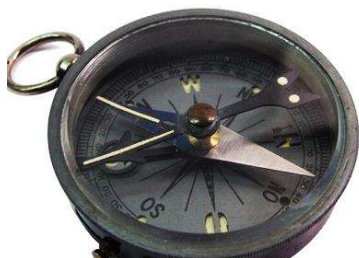
Seitliche Ansicht der rautenförmigen Nadel und Marschrichtungspfeil
