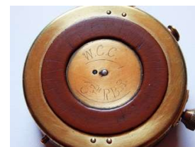
Gummiarmierung gegen Verrutschen auf der Karte
