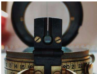
Glasprisma mit Spalt in der Kimme
