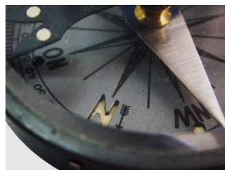
Deklinationspfeil bei 10 Grad WEST
