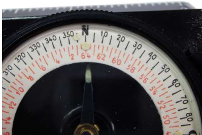
Deklinationskorrektur 5 Grad West mittels markiertem Punkt
