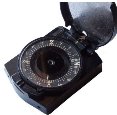
Marschkompass mit Wirbelstromdämpfung im Einsatz bei den Truppen Mussolinis
