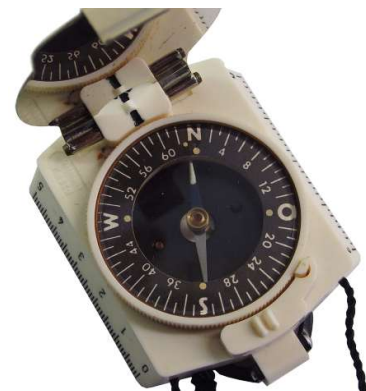
Skala 64-00 Strich rechtsdrehend und Deklinationsskorrektur
