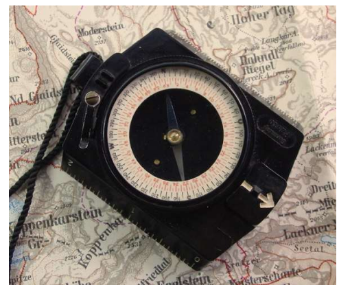
Modell Nr. 1 auf der Landkarte zum Herausgreifen der Marschrichtung
