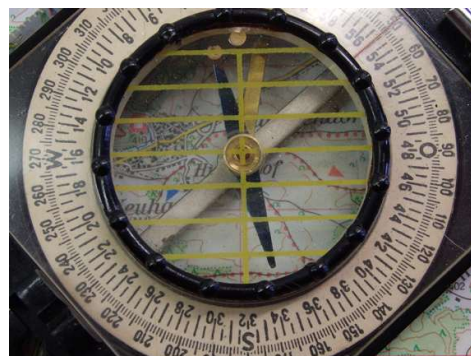
Orientierung auf der Landkarte mittels der West-Ost-Linien
