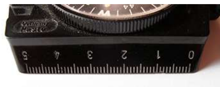
Anlegekante in cm mit der Einprägung Germany PASTO
