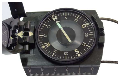
Anlegekante mit Skala
