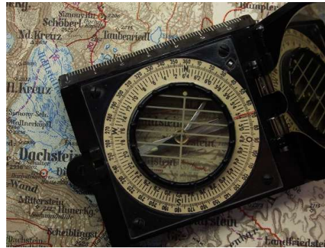
Einsatz des Marschkompasse auf der Landkarte mittels durchsichtiger Kompasskapsel und Gitterlinien D.R.P.
