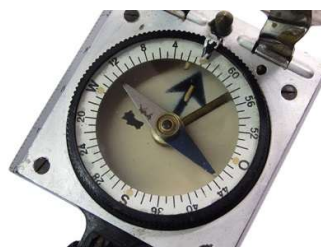
Jugendkompass C. Stockert & Sohn frühe 1930er Jahre Deklinationskorrektur bei ca 180 Strich WEST
