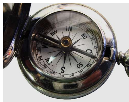
Modell Nr. 14 Skala mit Balkennadel und Inklinationsausgleich
