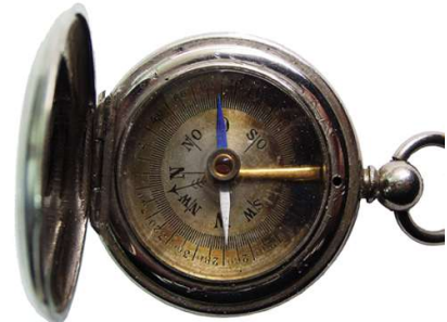
Skala mit Deklinationsspeil
