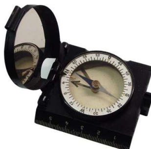
Pfadfinderkompass C. Stockert & Sohn Mitte der 1930er Jahre Deklinationskorrektur bei ca 150 Strich WEST
