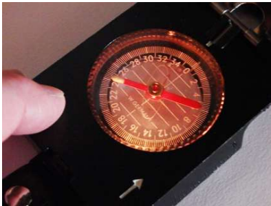
Die Beleuchtung wird mit Drücken eines Knopfes aktiviert
