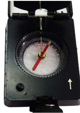
Kompasskapsel mit Beleuchtungsknopf
