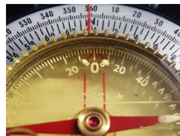
Anzeige der Deklinationsskorrektur in der Skala
