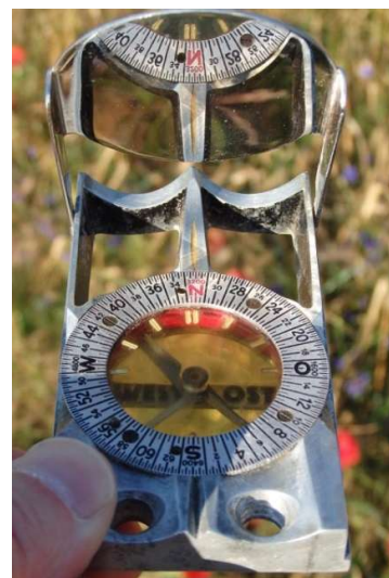
Stricheinteilung mit feststehender Skala und 32-00 Strich bei der Ablesemarkierung
