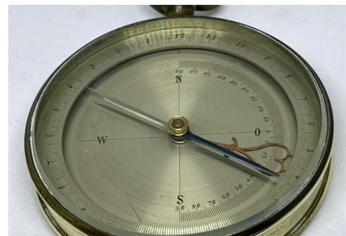
Skala der Markscheiderbussole in 2 x 12 Stunden mit Klinometer für die Neigungsermittlung
