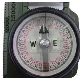
Skala des Lineatik-Kompasses mit Tritium Markierungen
