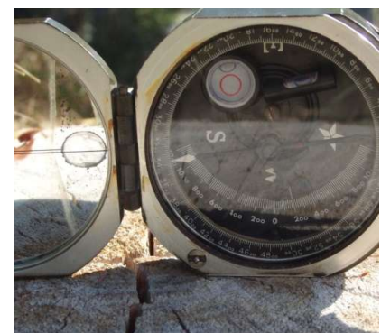
Ablesung der Neigung durch Einstellen der Röhrenlibelle
