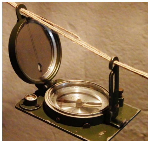
Freiberger Geologenkompass aus dem Jahre 1956
