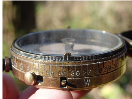
mittels Kimme und Korn wird nun das Ziel anvisiert und die Marschrichtung eingestellt abgelesen
