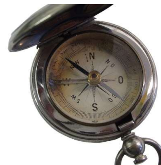
Taschenkompass in Uhrengehäuse auf Achathütchen
