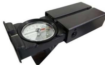
Peilkompass mit unten liegendem Spiegel
