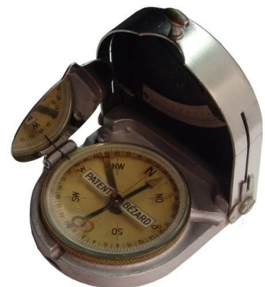
Orientierungsbusssole mit Neigungsmesser und um 32-00 Strich versetzter Skala
