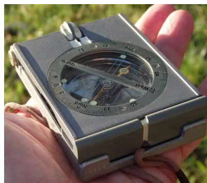
Einstellen der Marschrichtung an der seitlichen Rändelschraube
