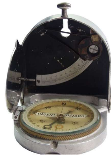
UBK - Bézar-Kompass der G. Lufft Metallbarometerfabrik
