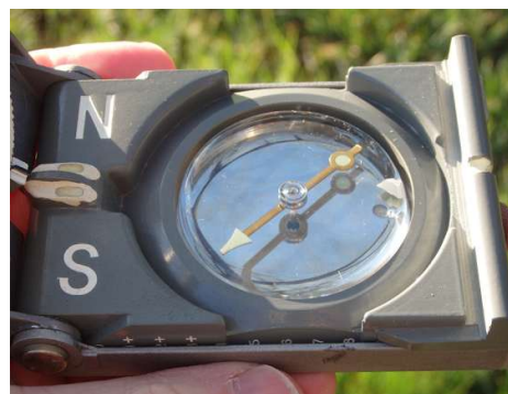
Kompasskapsel mit Magnetnadel
