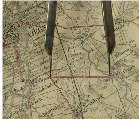
Strecke mit dem Stechezirkel abgreifen
