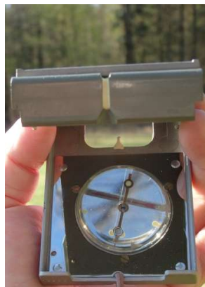
Anvisieren des Ziels über die am Deckel angebracht Kornmarkierung
