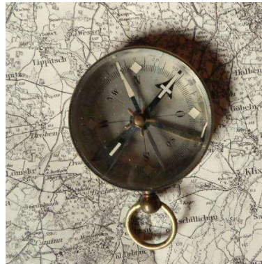
Bussole beim Einnorden mit Berücksichtigung der Deklination
