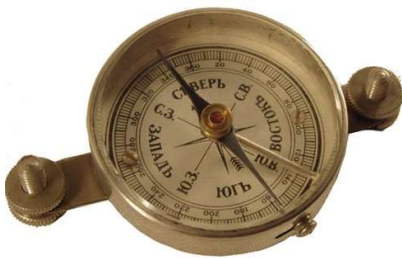
„Planchette-Kompass“ mit Gradeinteilung und Achatlagerung und Nadelarretierung
