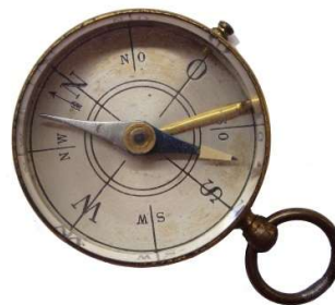
Taschenkompas mit Balmain und einer Metallskala
