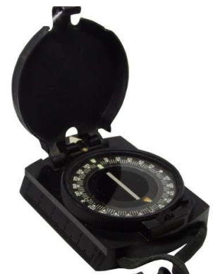
F-58 mit russischer Skala 360 Grad rechtsdrehend
