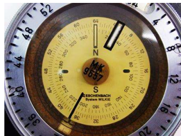
Schwimmende Kompassrose mit Deckelglas
