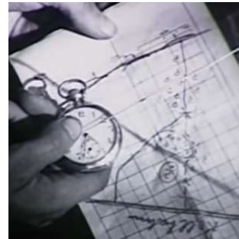
Ermitteln der Himmelsrichtung mittels Uhr und Einnorden der Marschskizze
