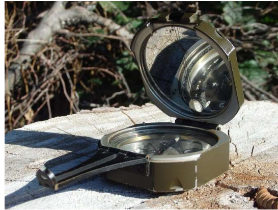
BRUNTON Geologenkompass, baugleich mit M2 Artilleriekompass der US Armee
