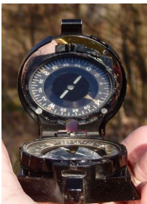
Vorläufermodell des Emil Busch MK Göttingen, Gehäuse aus Bakelit und ohne Visierstrich im Deckel
