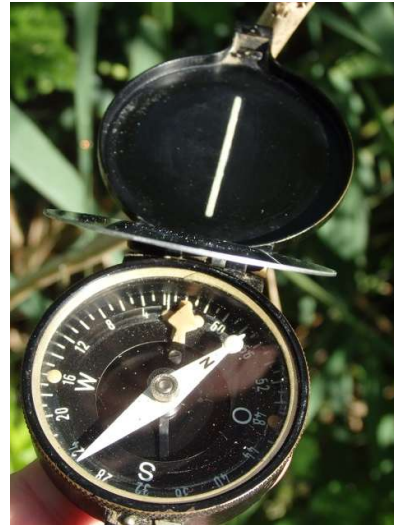
Marschkompass der Wehrmacht, ab 1936 mit Wiebelstromdämpfung
