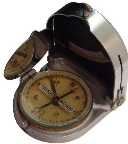
UBK – Patent-Bézard mit 32-00 Strich versetzter Skala
