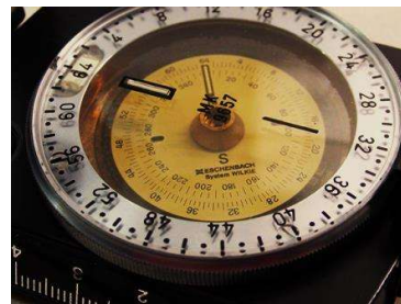
Schwimmende Kompassrose mit Deckelglas
