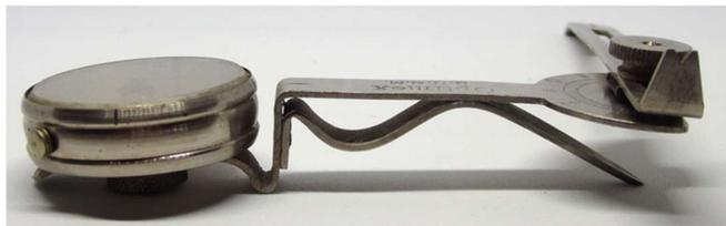
Standort auf dem Notizblock liegt nun genau unter dem drehbaren Richtungszeiger. Auf diesem Richtungszeiger ist nun ein cm-Maßstab eingraviert, sodass man sowohl die Entfernung als auch die Richtung ablesen und eintragen kann.
