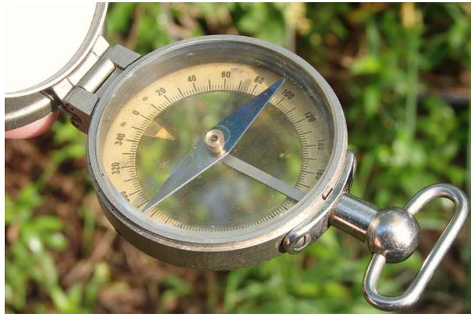
*Skala Marschkompass Kröplin Modell 2 mit zurückgeklappten Bodendeckel*
