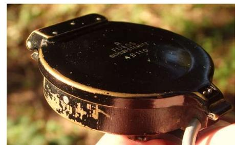
*Gehäuse mit eingeklappter Anlegekante*
