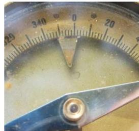
*Deklinationskorrektur mit 5 Grad West*
