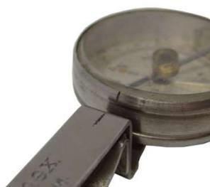
Markierungen am Gehäuse und der Kompasskapsel
