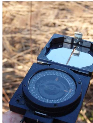
*Grobe Orientierung mit abgeklappten Deckel*
