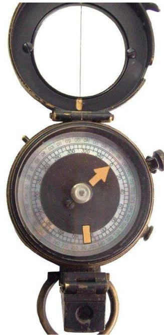
2,5 Grad, mit dem Prisma auf 0,5 Grad genau. Auf der Skala finden wir einen nachleuchtenden Nordpfeil. Diese hat ein radioaktives Leuchtmittel erhalten. Ebenso wie die verstellbare Markierung auf dem Deckglas. Diese ist dazu da eine ermittelte Marschrichtung einzuhalten. Hierzu wird die Marschrichtung zum Ziel ermittelt.
