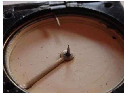
*Gehäuseboden mit Pinne und verstellbarem Deklinationsstift*
