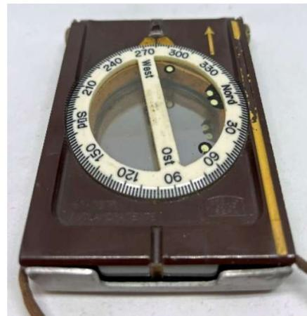
Kompassgehäuse aus Bakelit und einem Metalldeckel
