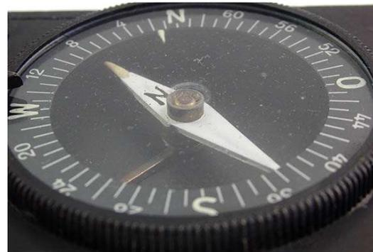
*Skala mit Deklinationskorrektur*
