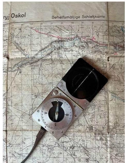
*Ermittels der Marschrichtung bzw der Schiessrichtung auf einer behelfsmässigen Schießkarte der 1940er Jahre*
