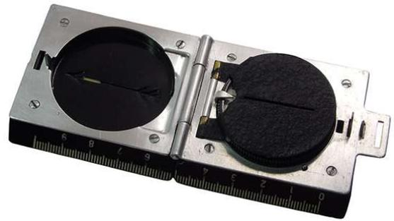
Bei dieser **Skala** haben wir einen weissen Teilring mit schwarzen Ziffern. Diese ist linksdrehend und in 64-00 Strich eingeteilt. Auch bei diesem Modell gibt es eine **Deklinationskorrektur**, welche bei 150 Strich WEST allerdings fest angebracht ist.
