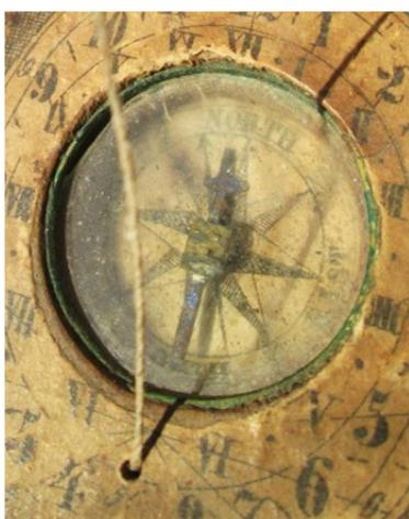
*Kompass-Skala mit Windrose und Magnetenadel*
