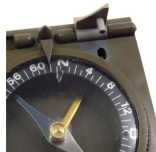
*Nadelarretierung durch umklappbaren Hebel*
