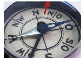
Natürlich verfügt das Modell über ein **Facettglas**, welches innen den roten Marschrichtungspfeil ab Werk aufweist. Vermutlich ein Vorgänger zu einem mechanischen Marschrichtungspfeil, welcher im folgenden Kapitel näher beschrieben wird.
