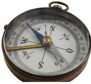
Skala mit Deklinationspfeil und Endfäden
