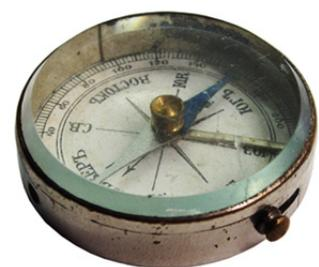
Das **Messinggehäuse** ist vernickelt und hat die Zeit bisher gut überstanden. Der Kompass hat einen Durchmesser von 35 mm und ist relativ schwer. Bei meinem Modell finden wir keinen Sonnenschliff. Ursprünglich hatte dieser Taschenkompass eine Öse, die im Laufe der letzten Jahre verloren gegangen ist.
