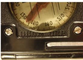
*Gehäuseboden mit Haltehebel und sichtbarer Skala*
