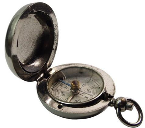
Mit dem Modell 773 knüpfte C. Stockert & Sohn an seine Tradition an Taschenkompassse in einem Uhrengehäuse einzubetten. Diese bestanden aus einem Messinggehäuse, welches vernickelt wurde. Es gab die Kompassse mit einer Papierskala oder auch, wie bei diesem Modell, mit einer Metallskala. Diese hat eine Einteilung in 360 Grad rechtsdrehend.
