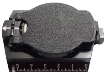
Das Bakelitgehäuse mit Deckel mit dem Haltehebel
