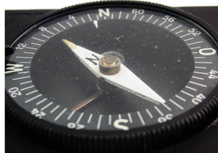
Kompassnadel mit Stabilisierungsring aus Kupfer
