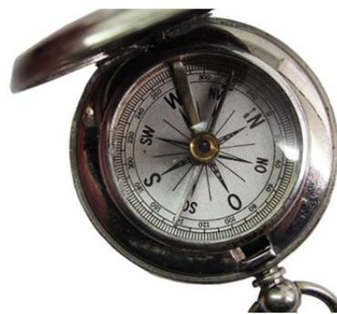
*Taschenkompass im Uhrengehäuse mit Sprungdeckel*
