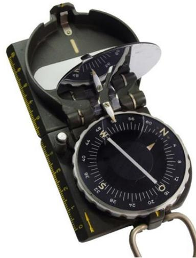
*Askania Handkompass der 1950er Jahre mit Wirbelstromdämpfung*
