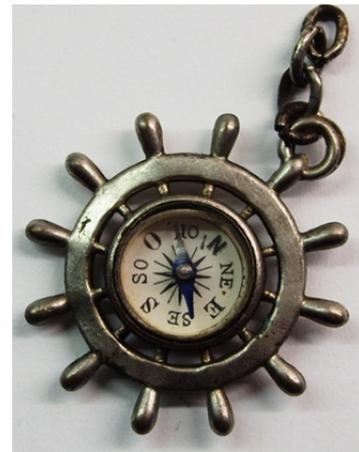
Wenn man den Rand des kleinen Kompasses näher anschaut, so erkennt man, dass dieser von einem Papierstreifen, der um den inneren Rand gelegt wird, begrenzt wird. Schaut man sich die Skala genauer an, so erkennt man dass diese auch für andere Kompassmodelle dieser Zeit verwendet wurden. Man erkennt noch ein grobes Raster für die Ablesung der Grade, was bei diesem Kompassmodell aber keinen Sinn ergibt.
