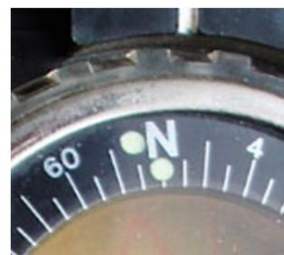
Wir haben bei der Kompassnadel keine Stabilisierungsflügel wie sonst bei WILKIE üblich. Dies ist selbst heute bei diesen Nadeln auch nicht unbedingt notwendig. Mittels einer transparenten Scheibe mit einer spitzen Nadel wurde die Kompassnadel am transparenten Gehäuseboden angeklebt. (Siehe auch das Modell Nr. 16 und die Touring Modelle von PASTO).
