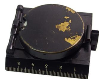
Der Deckel besteht aus Messing, das Gehäuse aus Bakelit
