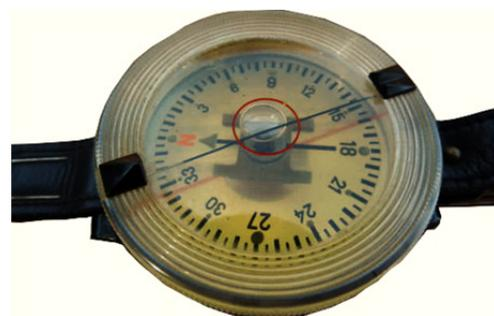
**Kimme und Korn** sind auf der Kompasskapsel befestigt. Mit dieser Visiereinrichtung kann das Ziel anvisiert und die Flugrichtung abgelesen werden.
