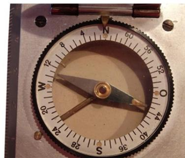
*Marschkompass I - Skala linksdrehend mit Deklinationsskorrektur*
