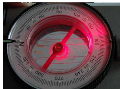
Eschenbach Marschkompass 6652 der 1980er Jahre mit zuschaltbarer Beleuchtung der Skala
