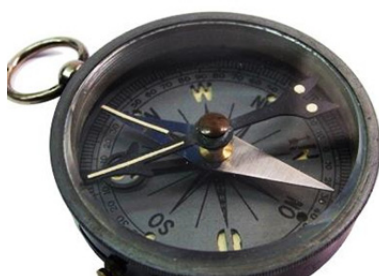
Seitliche Ansicht der rautenförmigen Nadel und Marschrichtungspfeil
