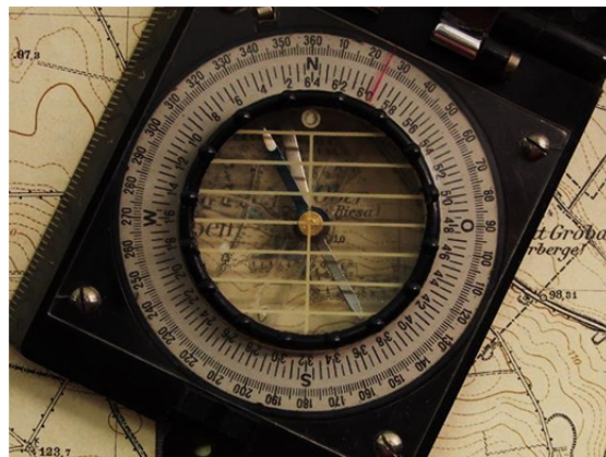
Skala mit Kompasskapsel. Steg zum Fixieren der Pinne ist transparent
