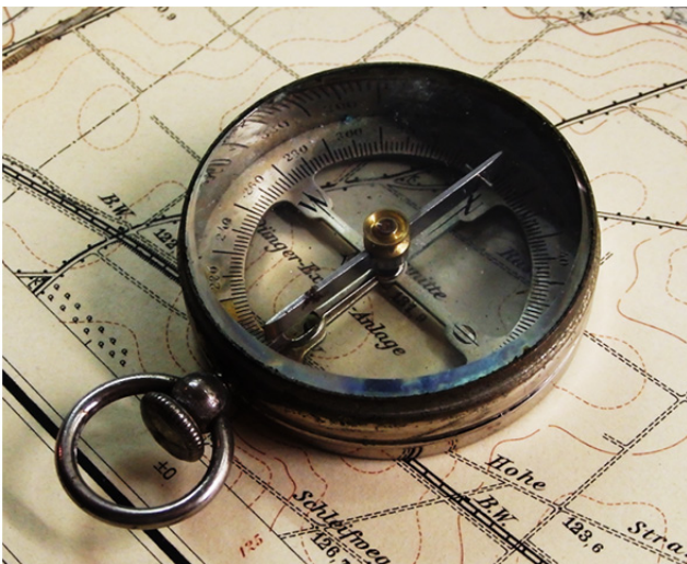
Die Balkennadel mit den Quergewichten zum Ausgleich der Inklination
