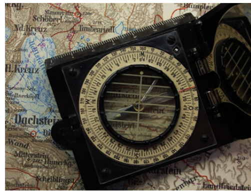
Einsatz des Marschkompasses auf der Landkarte mittels durchsichtiger Kompasskapsel und Gitterlinien D.R.P.
