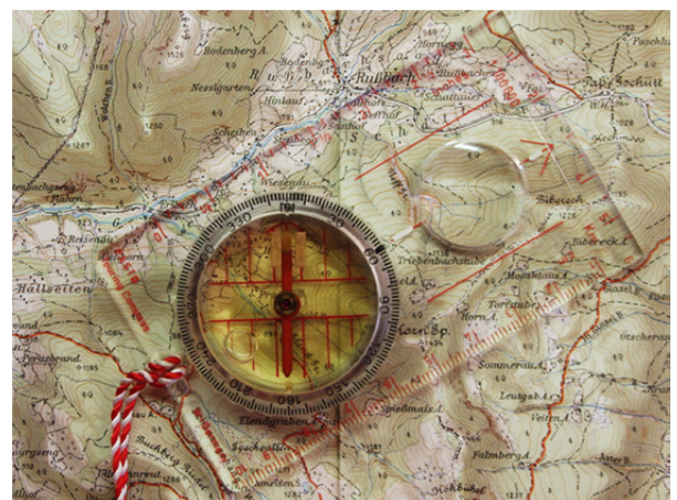
Einnorden der Karte mittels der transparenten Grundplatte und Ermitteln der Marschrichtung
