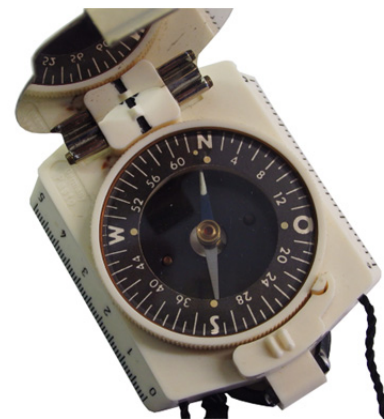
Skala 64-00 Strich rechtsdrehend und Deklinationsskorrektur
