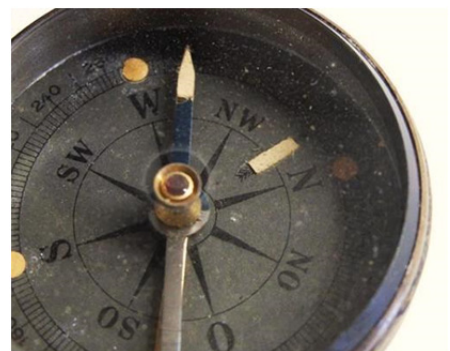
Skala mit Gradeinteilung und Achathütchen der Kompassnadel
