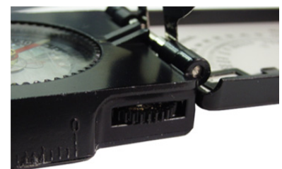
Rändelrad zur Einstellung der Skala / Marschrichtung
