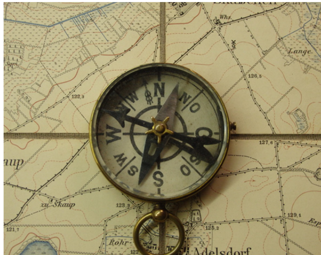
Taschenkompass Modell Nr. 7 nur bedingt als Kartenkompass geeignet
