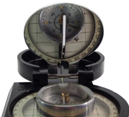
Verwendung als Marschkompass mit Nutzung des Spiegels
