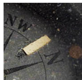
Deklinationspfeil mit Balmainpapier
