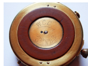
Gummiarmierung gegen Verrutschen auf der Karte
