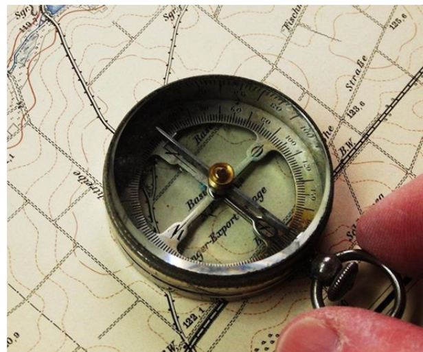
Die Handhabung eines Kartenkompasses an der Öse
