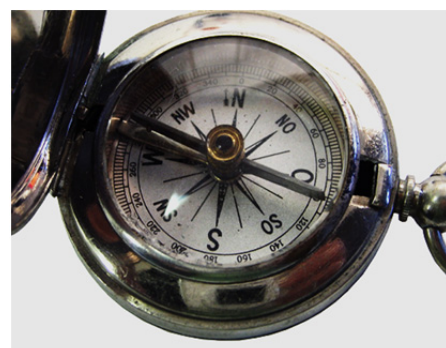
Modell Nr. 14 Skala mit Balkennadel und Inklinationsausgleich
