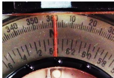
Kombinierte Skala in Grad und Strich
