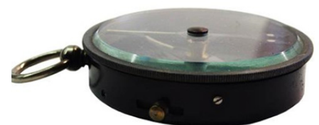
Facettglas drehbar mit Arretierknopf
