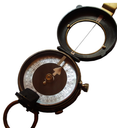
Perlmutterplatte für eine Ablesung selbst bei widriger Witterung
