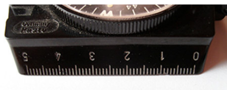
Anlegekante in cm mit der Einprägung Germany PASTO
