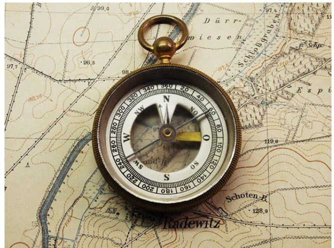
Singer & Söhne Kartenkompass auf einem Messtischblatt
