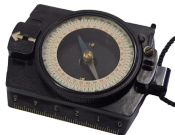
Marschkompass Modell Nr. 1, Paul Stockert OHG 1950er Jahre Deklinationskorrektur nicht fest
