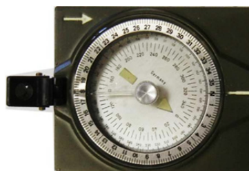
das Prisma mit der Kompassrose mit äußerem Teilring und innerer Einteilung in 360°
