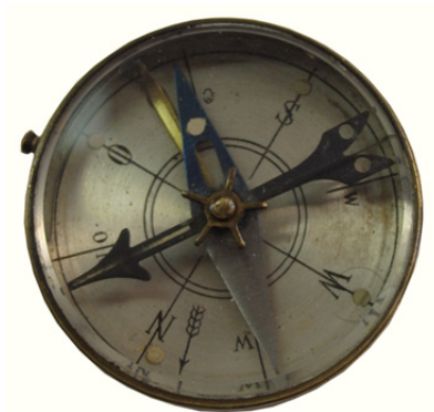
K. S. Stockert Modell Nr. 7 eigener Deklinationspfeil
