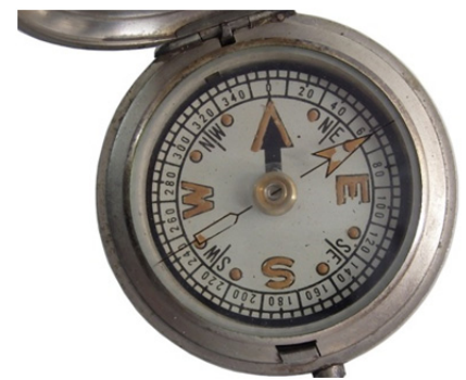
Skala mit nachleuchtenden Markierungen
