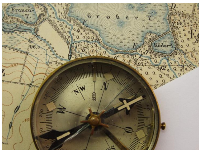
Herausgreifen der Marschrichtung aus der Landkarte mittels Papierstreifen, man erkennt der Houlliot Deklinationspfeil
