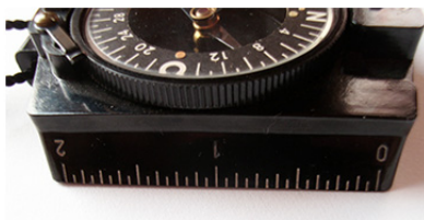
Anlegekante in inch mit dem Arretierhebel
