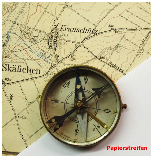
K. S. Stockert Modell Nr. 7 mit Metallskala ermitteln der Marschrichtung aus der Karte mittels Papierstreifen
