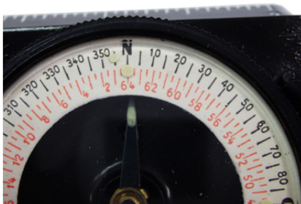
Deklinationskorrektur 5 Grad West mittels markiertem Punkt
