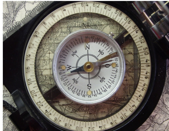
Carl von Stein - Nutzung als Kartenkompass auf einer Generalkarte 1:100.000
