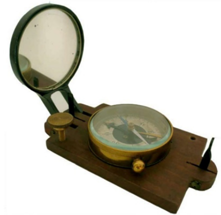
Houlliot-Planchette Kompass im eigentlichen Sinne
