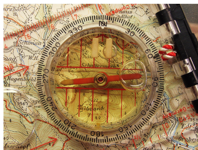
Ermitteln der Marschrichtung aus der Karte durch Anlegen der Ost-West Linie an Ortsnamen
