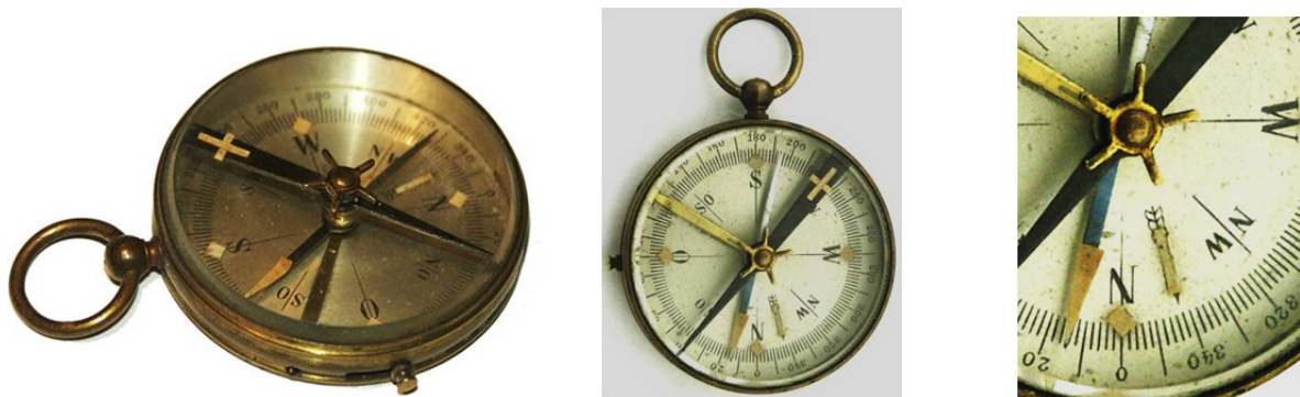
K. S. Stockert Modell Nr. 7 mit Direktionslinie, Balmainpapier und einem Houlliot Deklinationspfeil
