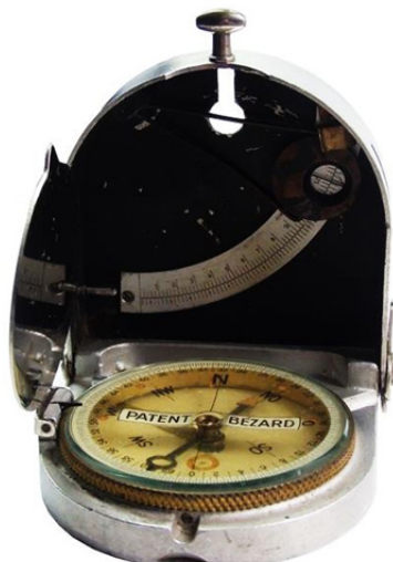
Patent- Bézar Kompass 1920er Jahre mit um 32-00 Strich versetzter Skala
