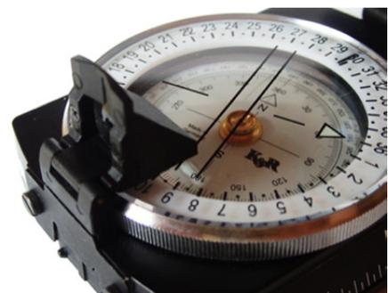
*Prisma höhenverstellbar und um 180 Grad zum Verschwenken*
