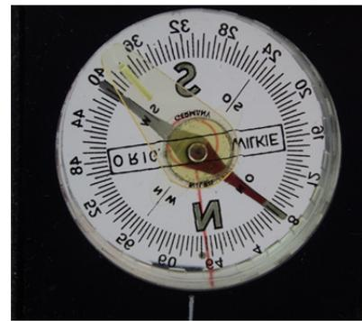
Verstellbare Deklinationskorrektur bei M 106 F
