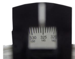
*Die Ablesung der Skala, leider mittels Kunststoffprisma und kein Glasprisma*
