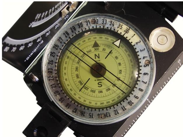
*Kompassrose mit äußerem Teilring und Inklinometer*
