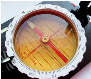
*Die WILKIE Stabilisierungsflügel der Kompassnadel und die Deklinationskorrektur auf dem Kapselboden (2 Bohrungen, hier sichtbar neben der neu gestalteten Kompassnadel)*
