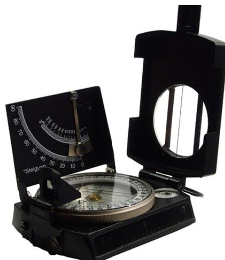
*Meridian Pro mit aufgeklappter Inklinometerskala*
