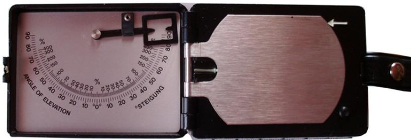
*Der Inklinometer kann ohne Probleme nach Freisetzen der Arretierung verwendet werden*
