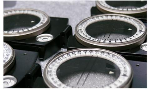
*auf das Gehäuse montierte Drehringglas*
