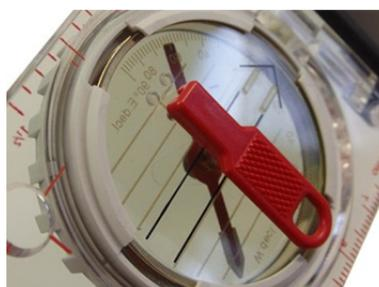
Stift für die **Deklinationskorrektur** kein Inklinometer
