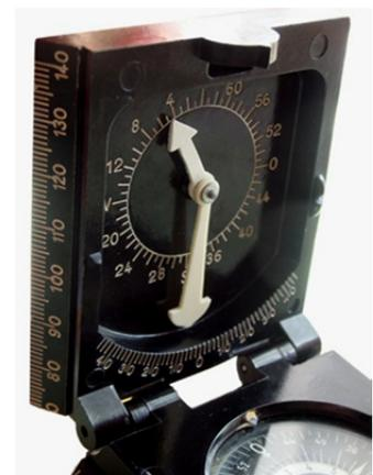
Über Kimme und Korn kann man mittels des Deckel auch Ziele anvisieren, um die Steigung bzw. das Gefälle zu ermitteln. Durch eine leichte Kippneigung des Deckel kann der in den Deckel eingearbeitete **Inklinometer** den Wert anzeigen. Hier erkennt man Ähnlichkeiten zum M 110 PN.
