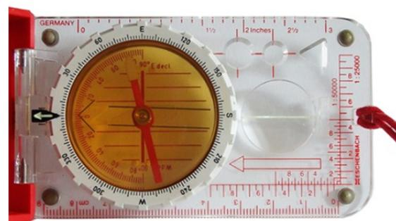
*BW 2 – Kunststoff Bodenplatte mit Planzeiger*
