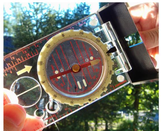
*Einsatz des Inklinometers für die Ermittlung von Steigungen bzw. Gefälle*
