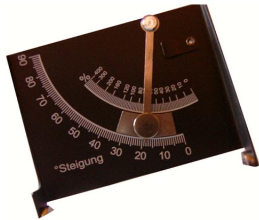
*Inklinometer mit der Ermittlung der Steigung bzw. Gefälle in Grad und Prozent*
