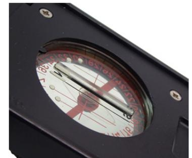
Deklinationsskorrektur mittels Steg verstellbar
