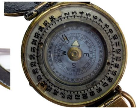
*Skala und äußerer Teilring des Mark III*
