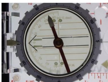
**Nadel** mit stabilisierenden Seitenflügeln, Teilring nicht nachleuchtend
