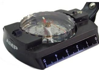
**M 106 FA** mit angeklebter Skala der Anlegekante beidseitig
