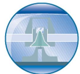
Außerdem ermöglicht die spezielle Konstruktion des **Saphirlagers** der Magnetnadel viel Neigungsfreiheit, um der Inklination entgegenzuwirken.
