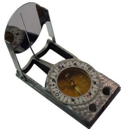
Ich visiere mit diesem Kompass wie mit einem modernen Kompass über Kimme und Korn das Ziel, hier ist es das Bergkreuz auf der Trisselwand, an. Nun drehe ich die Skala des Kompasses so weit, bis die **N-S Achse**, welche im Beispiel **gelb markiert** ist, horizontal ausgerichtet ist. Nun muss ich nur noch den Steigungswinkel zum Ziel, in unserem Beispiel in Altgrad, an der **Ablesemarke** ablesen. Die
