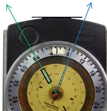
Nun müssen wir das Gehäuse des Kompasses nach Magnetisch Nord ausrichten, indem wir das Gehäuse des ganzen Kompasses drehen bis beide Nordmarkierungen deckungsgleich übereinstimmen. Wir erhalten unsere Marschrichtung zum nächsten (Zwischen-)Ziel. Die drehbare Kompassrose behält ihre Ausrichtung unverändert bei.
