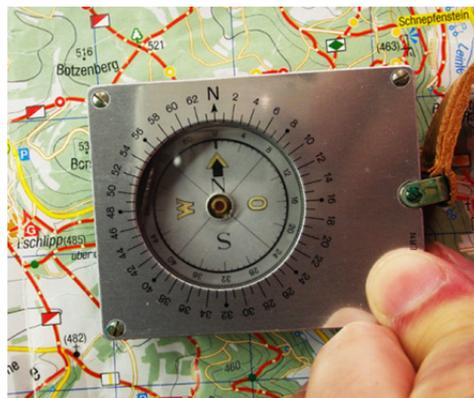
Die Ablesung von Horizontalwinkeln sollte daher auch immer mittels des Prismas erfolgen. Entfernungen können mit der 08-00 Strich Skala ohne Probleme ermittelt werden. Sie errechnen sich mit der **MKS-Formel**.
