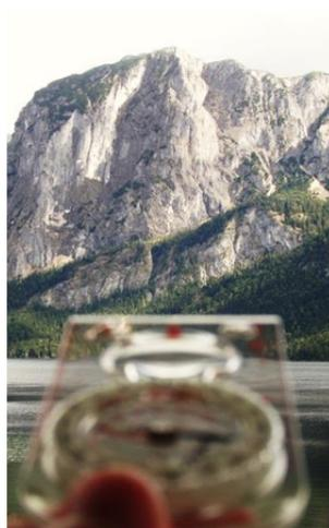
Gehäuse des Linealkompasses wird von der horizontalen in die vertikale Lage gebracht
