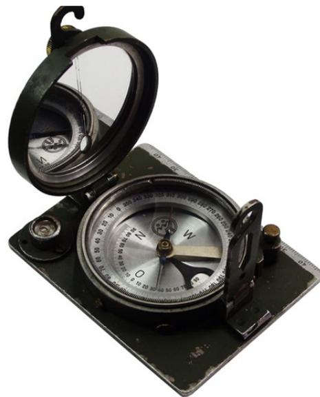
Der Teilkreis des Geologenkompasses ist fest und kann nicht, ganz entgegengesetzt als zu den Wanderkompassen, verdreht werden. Der magnetische Streichwinkel wird beim Geologenkompass ähnlich ermittelt wie bei den Kompassen der 1930er Jahre mit einer linksdrehenden Skala. Da wir auch beim Geologenkompass eine linksdrehende Skala haben, wird an der Magnetnadel die **Richtung** abgelesen. Ost und West sind vertauscht.
