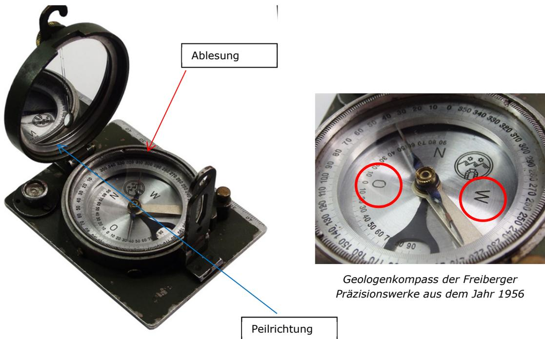
*Geologenkompass der Freiburger Präzisionswerke aus dem Jahr 1956*
