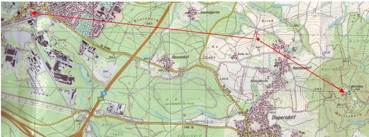
Messung zum Funkfeuer auf dem Moritzberg, zum einem Hochspannungsmasten und zur Kirche in Röthenbach. Ich wählte die Standpunkte 1 und 2 in Flucht zum Funkfeuer: einen außerhalb des Einzugsbereiches der Hochspannungsleitung und direkt unterhalb der Hochspannungsleitung.
