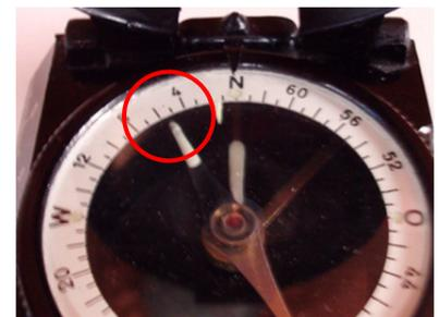
**Bild oben:** C. Stockert & Sohn Kompass „Pfadfinder“ aus dem 1940er Jahren mit fest eingestellter Deklinationskorrektur. Die Ablesung erfolgt an der Kompassnadel 05-50 Strich.
