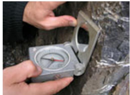
Am roten bzw. schwarzen Ende der Kompassnadel wird die Einfallsrichtung abgelesen. Mit Hilfe der Dosenlibelle wird der Kompass horizontal ausgerichtet. Mit dem Drücken des Arretierknopf wird die Kompassnadel zur Messung entriegelt. Die Freiburger Geologenkompass dienen primär zur Bestimmung der Raumlage von Gesteinsstrukturen werden aber auch zur geologischen Kartierung genutzt.
