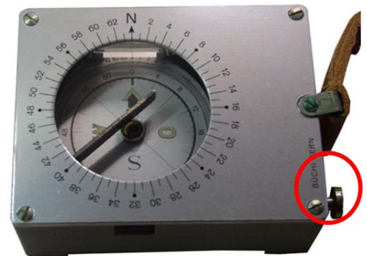
Man kann diese Kompassrose auch zur Geländeorientierung verwenden, ähnlich wie bei einem „normalen“ Peilkompass. Nach der Gebrauchsanleitung aus dem Jahr 1924 sollte man mit einem Auge die Werte, welche im Sitometer angezeigt werden, mit dem anderen Auge das Gelände beobachten. Ich hingegen bevorzuge die Möglichkeit mit einem Auge sowohl das Gelände anzuvisieren als auch die Skala abzulesen.
